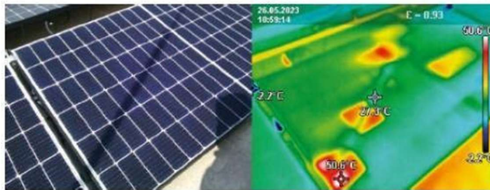
Verschattung und Hotspots durch Blitzfangstange 2
