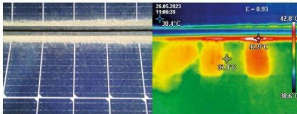
Verschattung und Hotspots durch Verschmutzung 1
